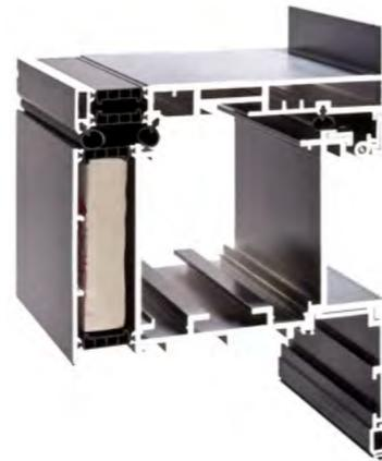
Profil en aluminium à rupture de pont thermique par barrette isolante en polyamide à cellules fermées de 39 mm
